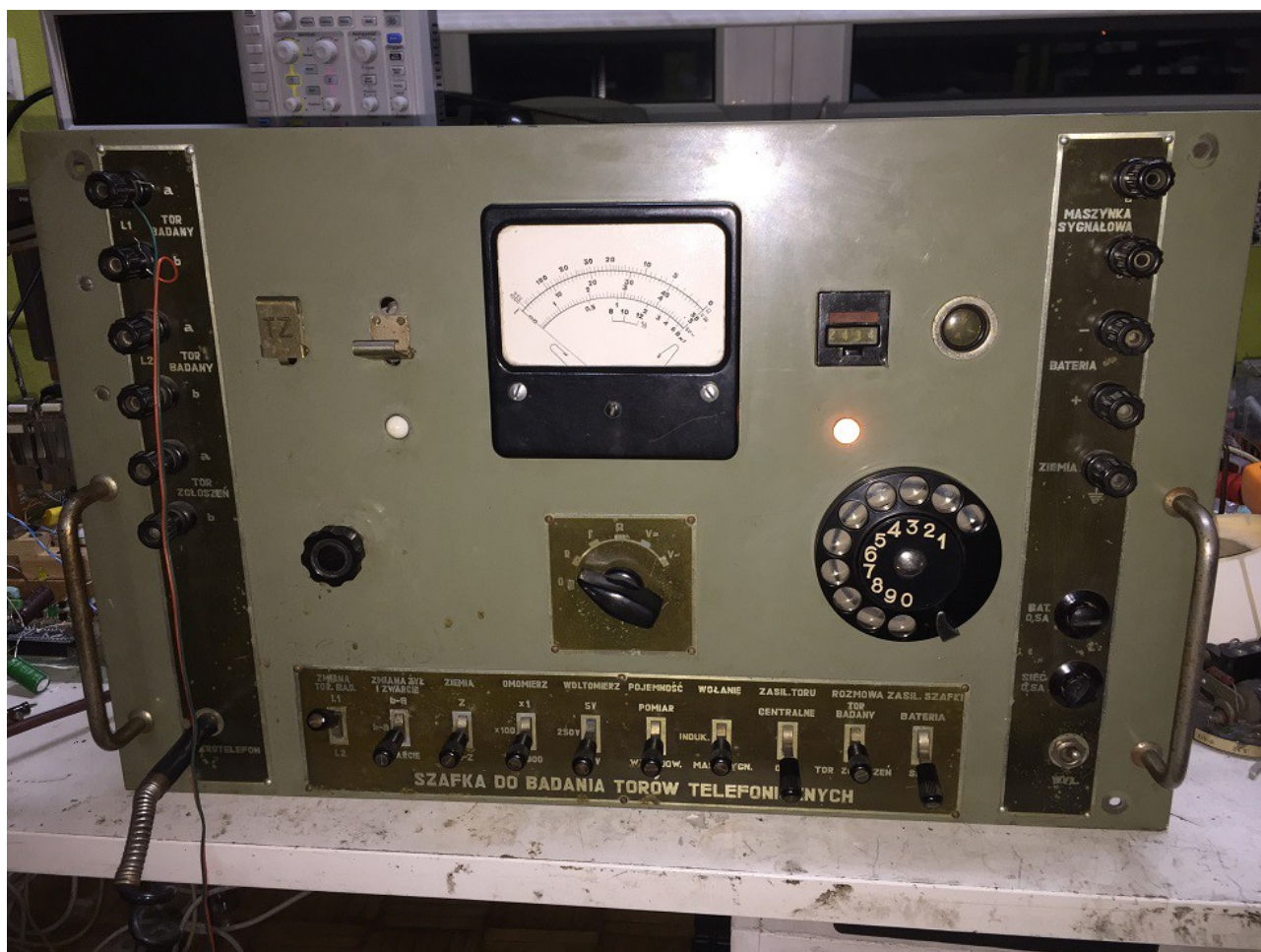
Rys. 4. Wołanie przez abonenta w torze badanym (opadła klapka TB).
