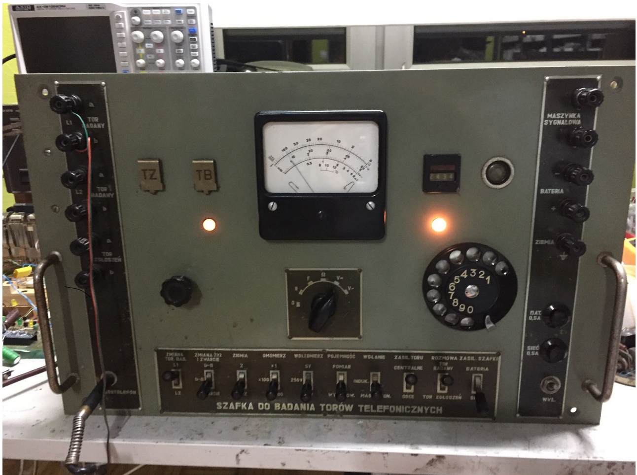
Rys. 8. Pomiar napięcia stałego (zakres 250V).
