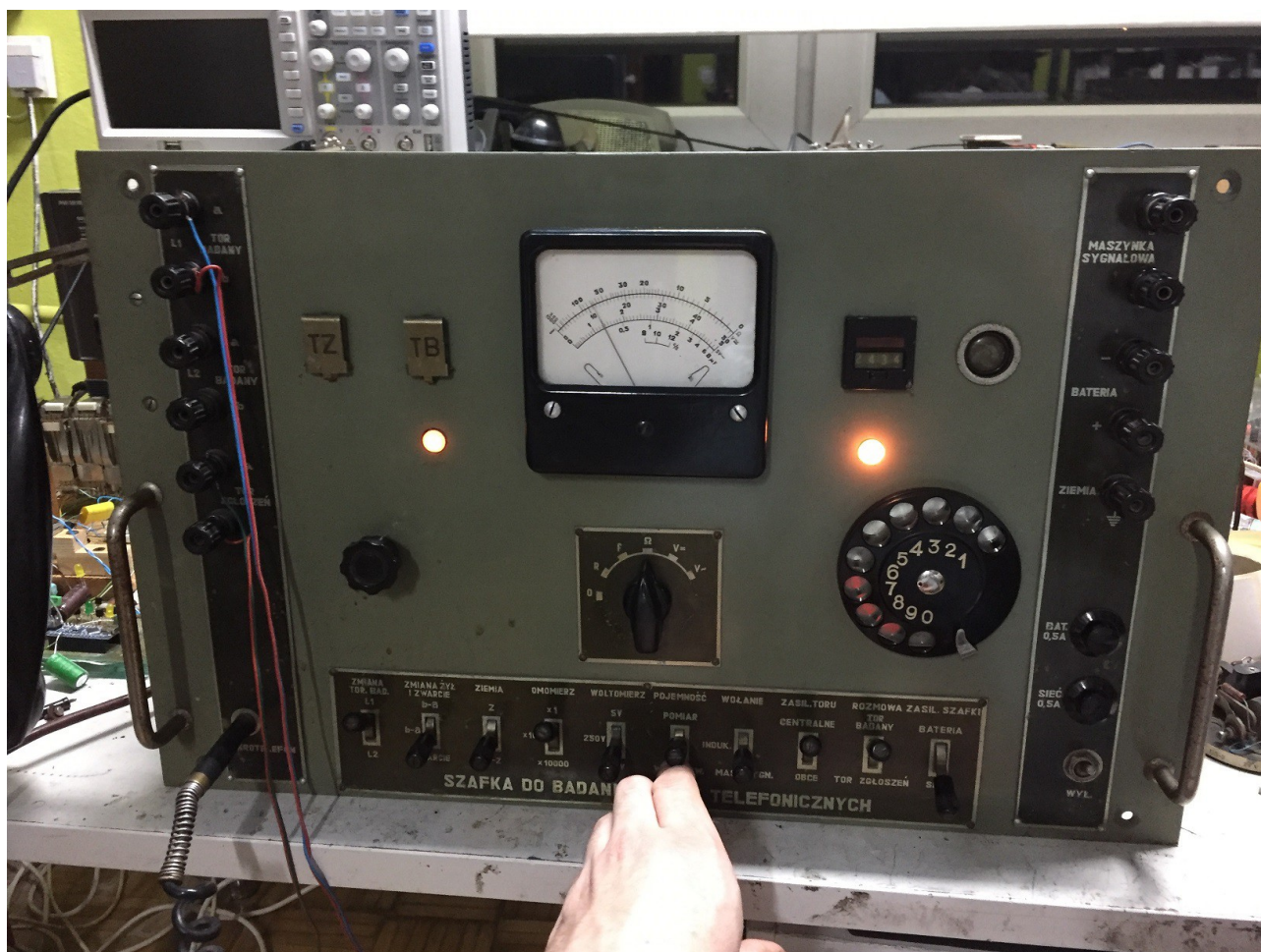
Rys. 7. Pomiar oporności (mnożnik x1).
