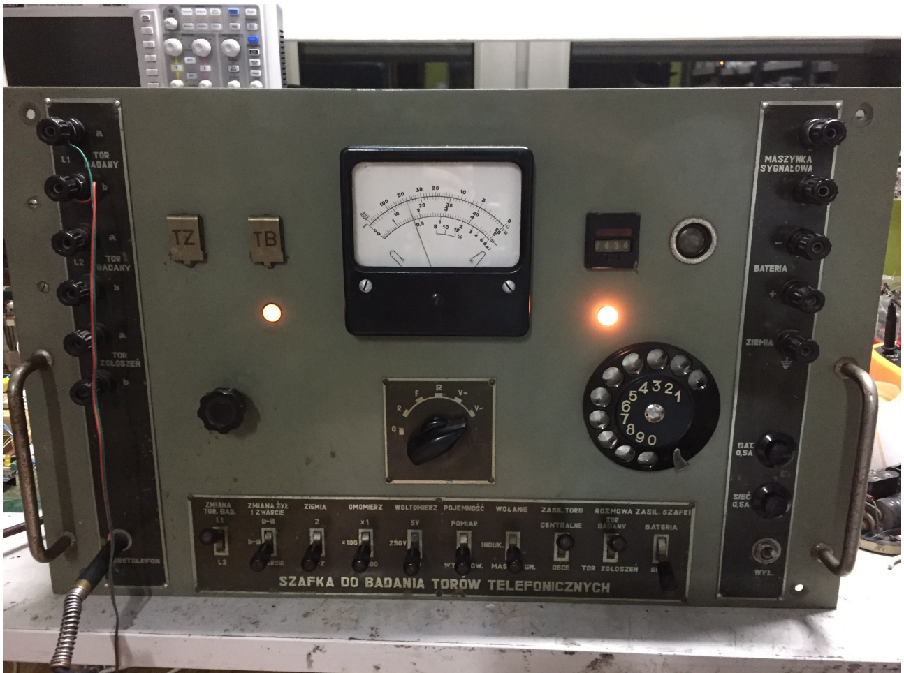
Rys. 9. Pomiar napięcia zmiennego (zakres 250V).
