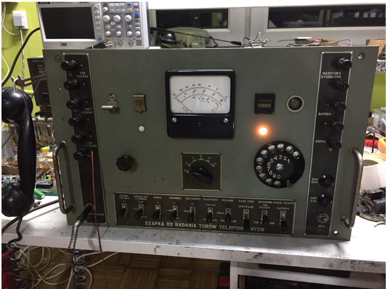
Rys. 6. Wołanie przez abonenta w torze zgłoszeń (opadła klapka TZ).
