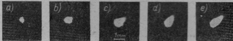
Rys. 3. Kształty plamek na ekranie dla różnych położań cewki ogniskującej; odległość środka szczeliny od połączenia kolby lampy z szyjką: a — 3 cm, b — 5 cm, c — 7 cm, d — 9 cm, e — 12 cm
