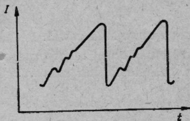
Rys. 30. Zniekształcenia przebiegu prądu odchyłającego wprowadzane przez cewkę odchyłającą
