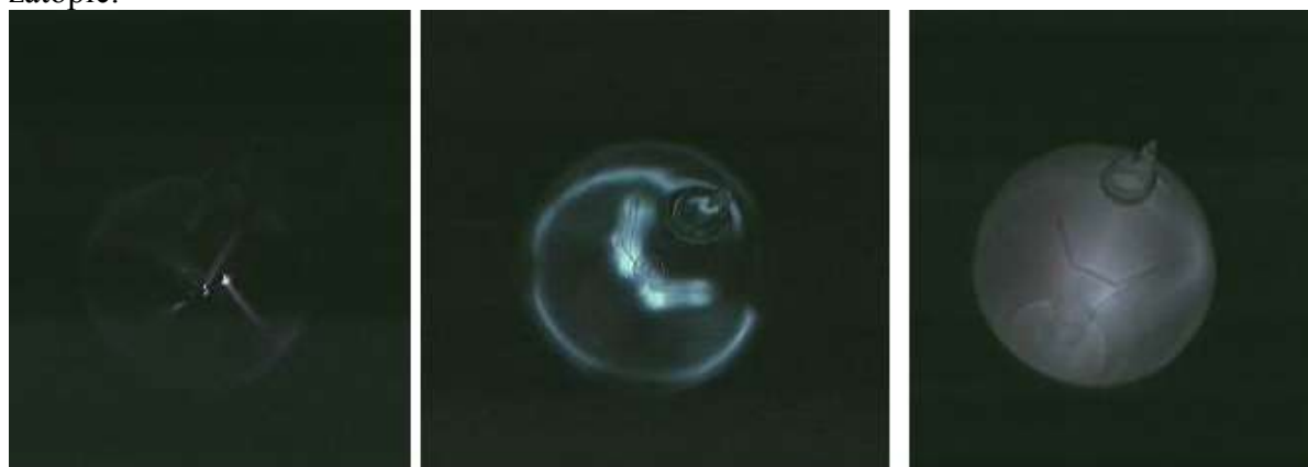
fot.4. Zmiana obrazu wyładowania w bańce żarówki podczas odpompowywania dla dwutlenku węgla. Ciśnienia kolejno od lewej ok. 30Tr, ok. 1 Tr, ok 10^{-2} Tr
