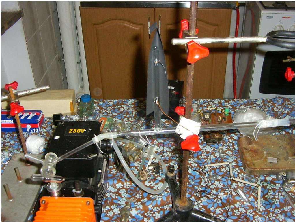
fot.3. Widok pompy i kranu (fragment układu pompowego do 10^{-2} Tr)
