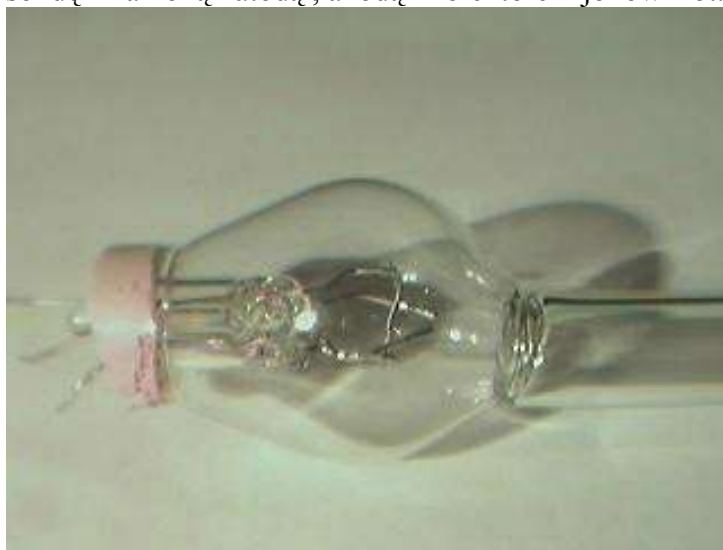
fot.1. Sonda jonizacyjna z żarówki samochodowej
